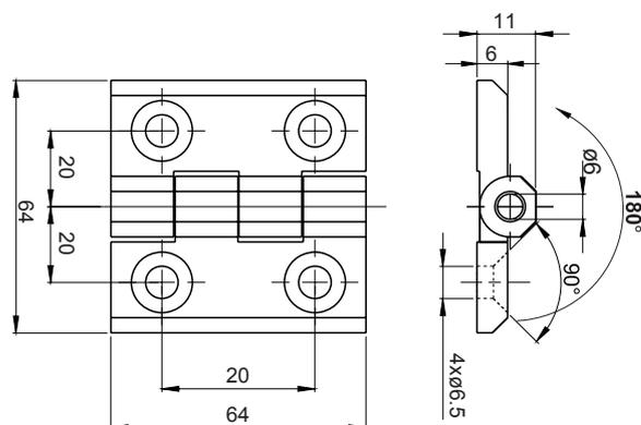
Cerniera avvitabile per vite M6
